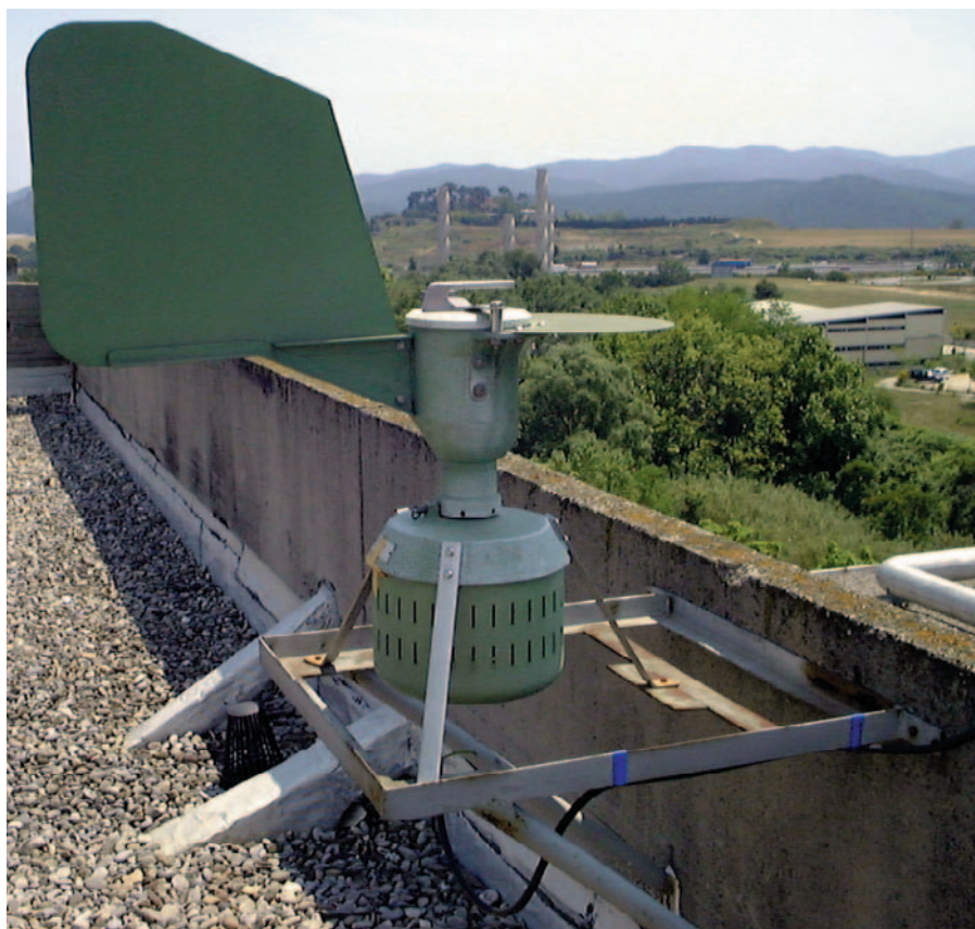
FIGURA 6. Captador Hirst marca Burkard.
