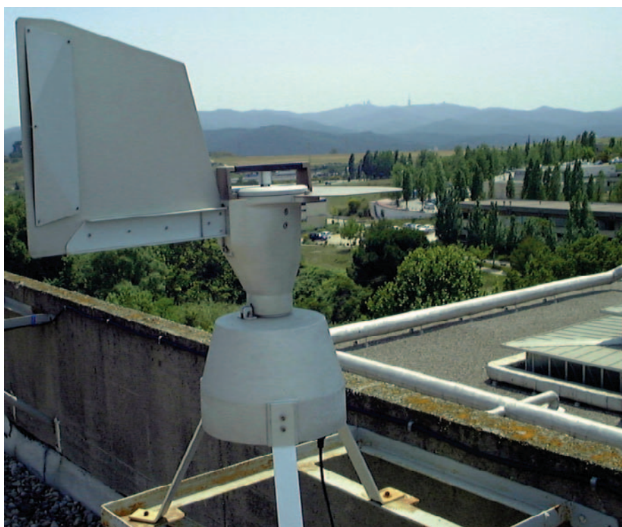
FIGURA 7. Captador Hirst marca Lanzoni.
